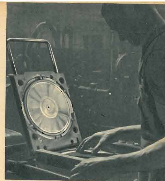
Riscaldata a 150°C, questa piastra stampante produce sessanta dischi all'ora. Con una stessa matrice si possono fare all'incirca 5000 dischi.
