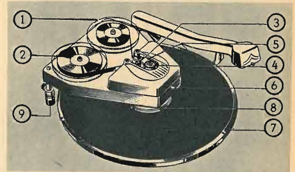
● Il magnetofono Filmagna può essere applicato sul piatto di un qualsiasi giradischi dal quale riceve il movimento necessario per il suo funzionamento. Esso è dotato di una sola testina, che serve per la registrazione o per la riproduzione. In basso, particolari dell'apparecchio: 1) bobina piena di nastro; 2) bobina senza nastro; 3) perno di guida; 4) rullo trascinatore; 5) testina magnetica; 6) interruttore testina; 7) piatto giradischi; 8) piattello del rullo; 9) piedino per regolare l'orizzontalità dell'apparecchio.
