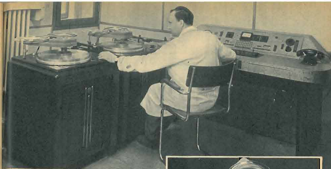
● Magnetofono Filmagna del tipo professionale per radiodiffusione o per studi cinematografici.
