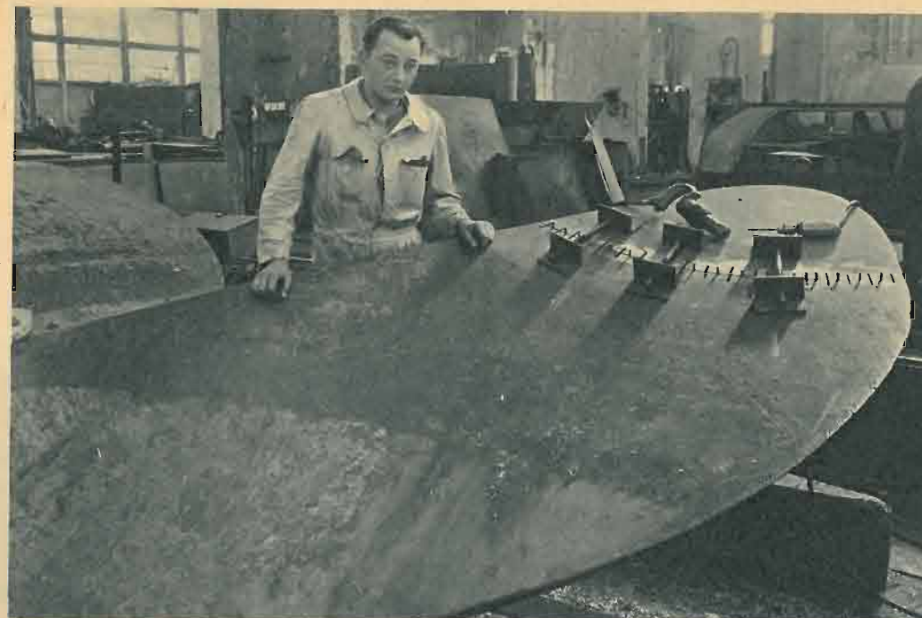
RIPARAZIONE DI UNA PALA DI ELICA MEDIANTE CUCITURA DEL PEZZO SOSTITUITO
